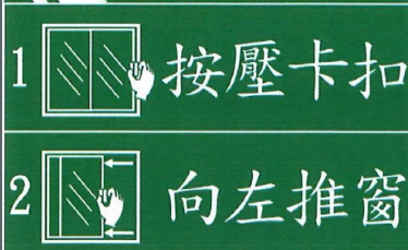
圖六：安全窗及車窗擊破裝置操作方式
