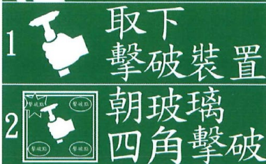
圖六：安全窗及車窗擊破裝置操作方式
